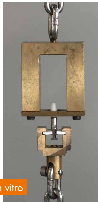
Foto*: Setup sperimentale - test di resistenza alla trazione (Velocità del provino di 2 mm/min)
